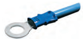
Conducteur insuffisamment dénudé
